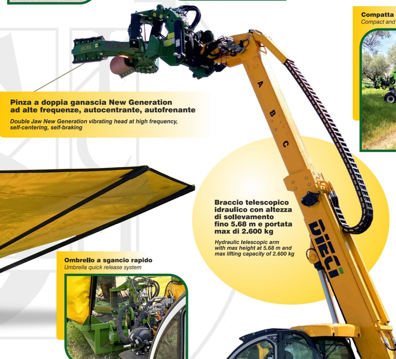
**Braccio telescopico idraulico con altezza di sollevamento fino 5,68 m e portata max di 2.600 kg**
