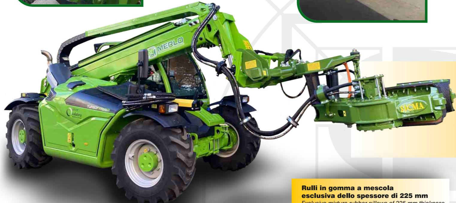
**Pinza a doppia ganascia New Generation ad alte frequenze, autocentrante, autofrenante con apertura della pinza fino a 60 cm**
