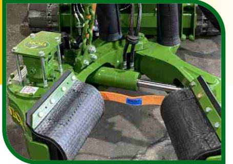
**Controllo idraulico della botola di scarico**
