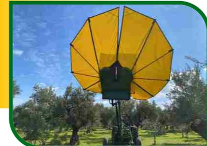
**Aggiunto al sistema a 3 punti, con serbatoio e gruppo idraulico indipendente azionato dalla PTO (540 rpm)**
